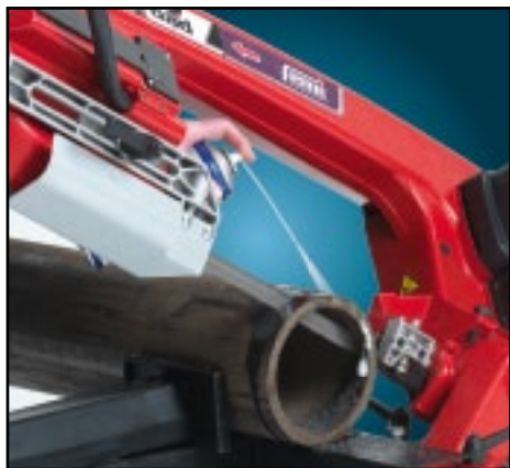
Possibilità di effettuare tagli con lubrificazione. Possibilité d'effectuer coupes avec lubrification.
