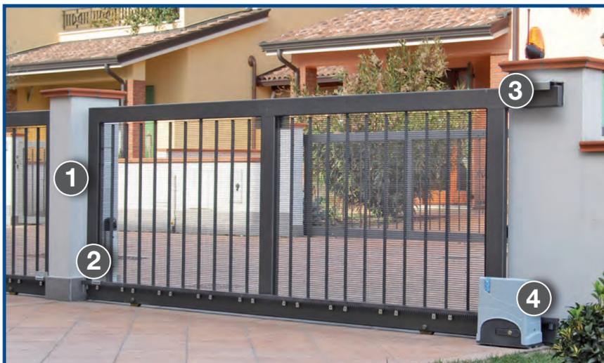
Il JUNIOR 624 è un apricancello elettromeccanico con motore in bassa tensione a 24V cc, progettato e sviluppato nel rispetto delle normative di sicurezza EN 12445, EN 12453 e della norma di prodotto EN 13241: rilevando un qualsiasi ostacolo presente in apertura o in chiusura, libera o inverte il movimento fino alla completa apertura.
