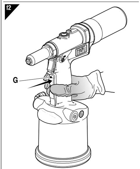
L'aspirazione si avvia alla pressione della leva (G) come in figura (fig. f2).
