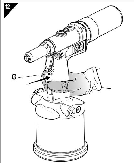
La aspiración se pone en marcha por la presión de la palanca (G) como en la figura (fig. f2).
