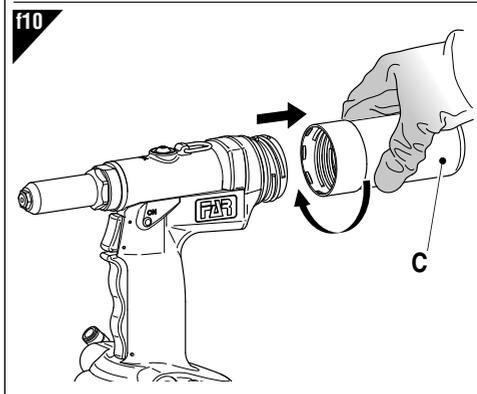
Aby zamontować osłonę zatrzymującą gwóźdź (T), stosować się do następującej procedury: po zdemontowaniu pojemnika na gwóźdź (C) (rys. f10), zdemontować pokrywę (R) i zamontować redukcję (S) na złączce; wsunąć osłonę zatrzymującą gwóźdź (T), wywierając lekki nacisk.
