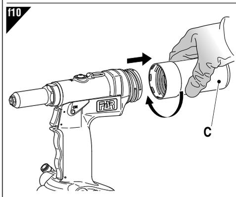
Порядок установки отбойника (Т) следующий: после снятия приёмника хвостовиков (С) (рис. f10) снимите крышку (R), установите переходник (S) на штырь лёгким нажимом и затем подсоедините отбойник (Т).
