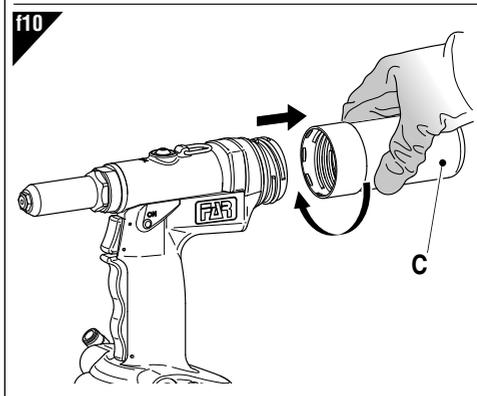
Pour l'assemblage du déflecteur (T) vous devez: enlever le conteneur de clous (C) (fig. f10), enlever le couvercle (R), mettre la réduction (S) sur le raccord et, avec une légère pression, insérer le déflecteur (T).
