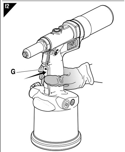
Die Absaugung wird bei dem Druck der Taste (G) aktiviert, wie in der Abbildung (f2) gezeigt ist.
