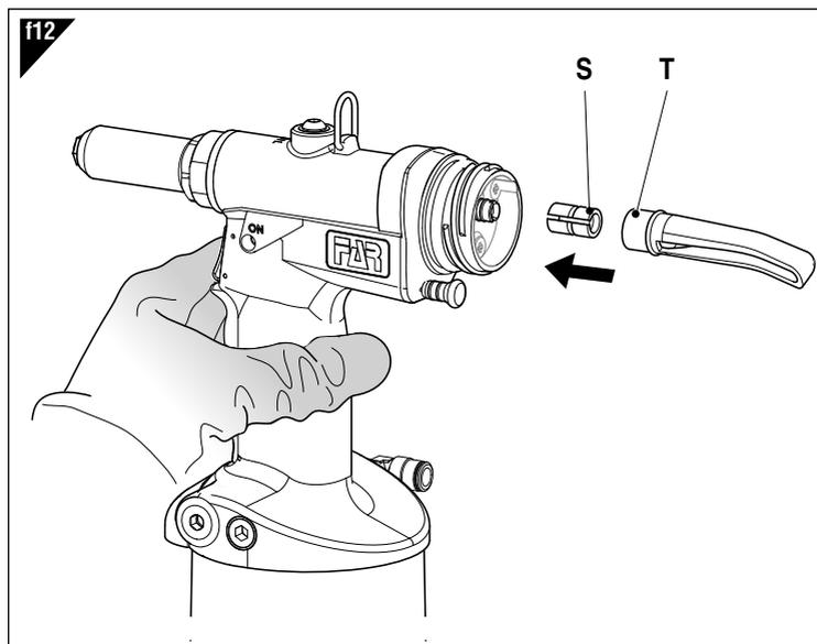
W przypadku konieczności odprowadzenia uciętych gwoździ do pojemnika, zdemontować z nitownicy osłonę zatrzymującą gwoździe (T) oraz redukcję (S).
