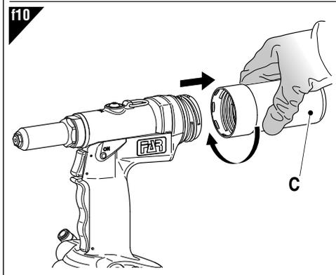
Per l'assemblaggio del deflettore (T) procedere come segue: rimosso il contenitore chiodi (C) (fig. f10), rimuovere il coperchio (R), montare la riduzione (S) sul raccordo e con una leggera pressione inserire il deflettore (T).
