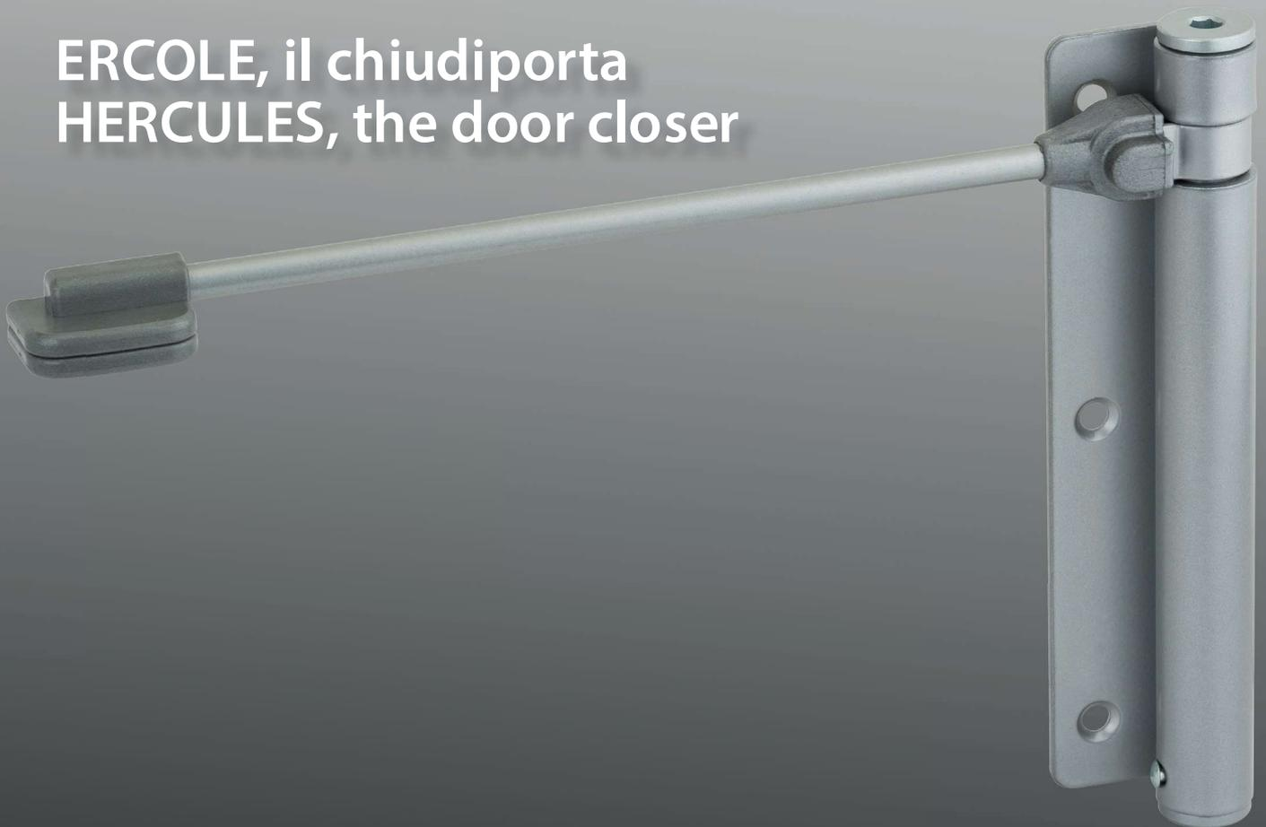
Il nuovo chiudiporta "Ercole" è progettato per garantire la chiusura di porte fino a cm 210 di altezza e cm 90 di larghezza con peso fino a kg.60. La forza di spinta è facilmente regolabile ed è possibile aumentare o diminuire la carica della molla con una semplice chiave a brugola.
