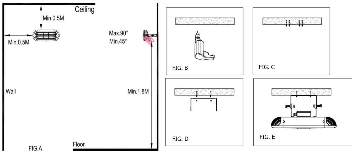
**ATTENTION :** Le réchauffeur doit être installé sur des murs exempts de matériaux combustibles placés directement au-dessus de l'appareil ou à proximité immédiate. Dans ce cas, placer le produit à une distance minimale d'1 m du plafond, des murs et d'autres matériaux thermosensibles
