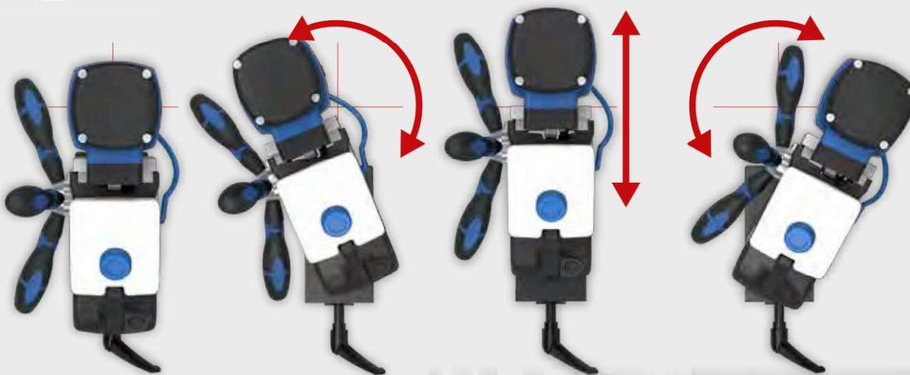
La caratteristica base orientabile BDS consente di posizionarsi con precisione sul lavoro, con il magnete già attivato. La macchina può essere così orientata di 20° sulla destra e sulla sinistra e mossa longitudinalmente di 15 mm avanti e indietro senza problemi.
