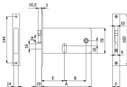
**CARATTERISTICHE COSTRUTTIVE:** Scatola e coperchio in acciaio zincato e plastificato - Frontale in acciaio nichelato e cromato - Catenaccio e scrocco in lega speciale nichelata - Pistone di ricarica in acciaio nichelato - Ingegno maniglia in ottone foro  $\varnothing$  8 mm - Gruppo bobine cod. 035 (12V-15W a.c.) CE.
