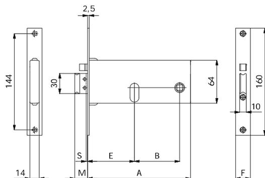
**CARATTERISTICHE COSTRUTTIVE:** Scatola e coperchio in acciaio zincato e plastificato - Frontale in acciaio inox - Scrocco in lega speciale nichelata - Pistone di ricarica in acciaio nichelato - Ingegno maniglia in ottone foro  $\varnothing$  8 mm - Gruppo bobine cod. 035 (12V-15W a.c.) CE.
