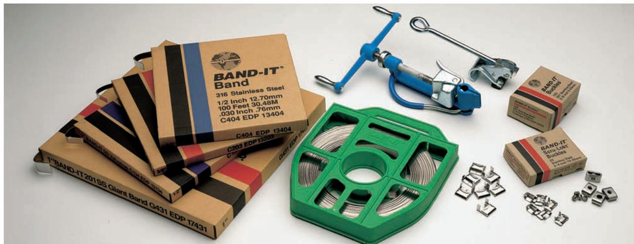
**Caratteristiche:** sistema composto da nastri metallici (C202÷C206) e graffe (C252÷C256) con il quale è possibile realizzare serraggi di qualsiasi forma e diametro. E' utilizzato per una grande varietà di applicazioni come serraggio di tubi in gomma in genere, fissaggio di segnaletica stradale ecc. Il tensionamento avviene tramite l'utensile BAND-IT (C001)
