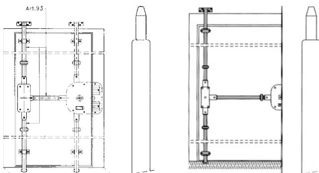
tipologia: aste telescopiche di derivazione, terminale cementato e rotante (antitaglio), puntale diametro 10 mm
