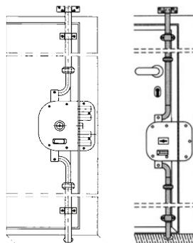
tipologia: aste telescopiche curve, terminale cementato e rotante (antitaglio)
