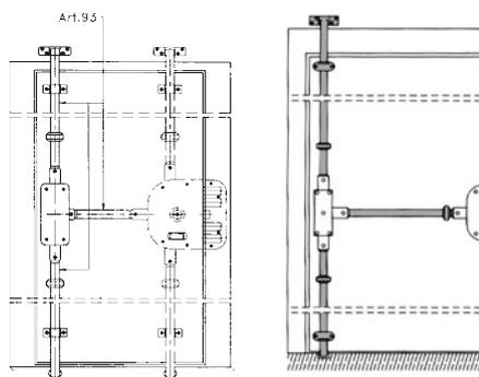
tipologia: aste telescopiche di derivazione, terminale cementato e rotante (antitaglio)
