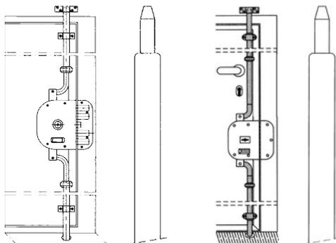
tipologia: aste telescopiche curve, terminale cementato e rotante (antitaglio), puntale diametro 10 mm
