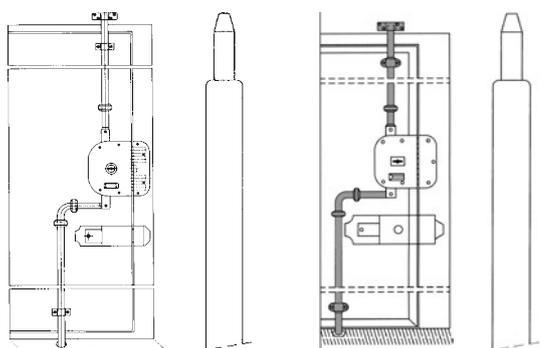
tipologia: aste telescopiche sbilanciate, terminale cementato e rotante (antitaglio), puntale diametro 10 mm
