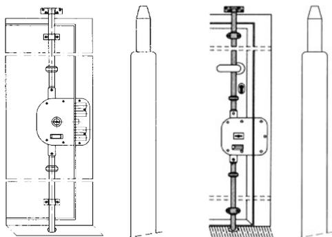
tipologia: aste telescopiche verticali, terminale cementato e rotante (antitaglio), puntale diametro 10 mm
