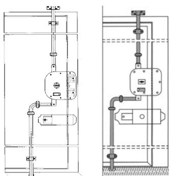
tipologia: aste telescopiche sbilanciate, terminale cementato e rotante (antitaglio)
