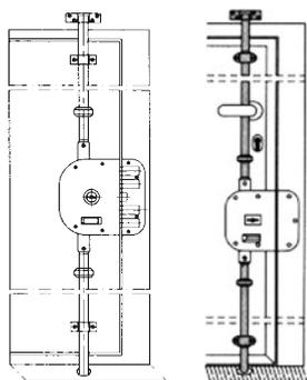
tipologia: aste telescopiche verticali, terminale cementato e rotante (antitaglio)
